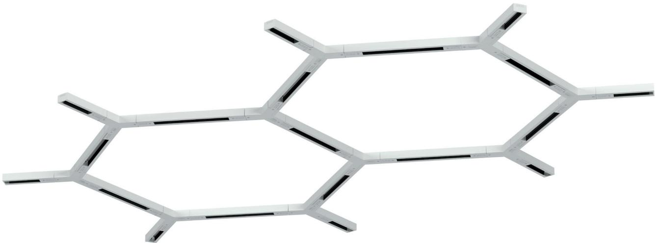
**5-Leiter Aufbauschiene** für einen Stromkreis plus Datenbus, bestehend aus einem stranggepressten Aluminiumprofil und zwei PVC-Trägerprofilen mit jeweils einem eingebetteten 2,5 mm<sup>2</sup> und 1 mm<sup>2</sup> Kupferleiter, Schutzleiter über das Aluminiumprofil. Eine bauseitige Längenanpassung kann problemlos durch einfaches Sägen vorgenommen werden. Ein Rückschneiden oder Biegen der Kupferleiter ist nicht notwendig.
